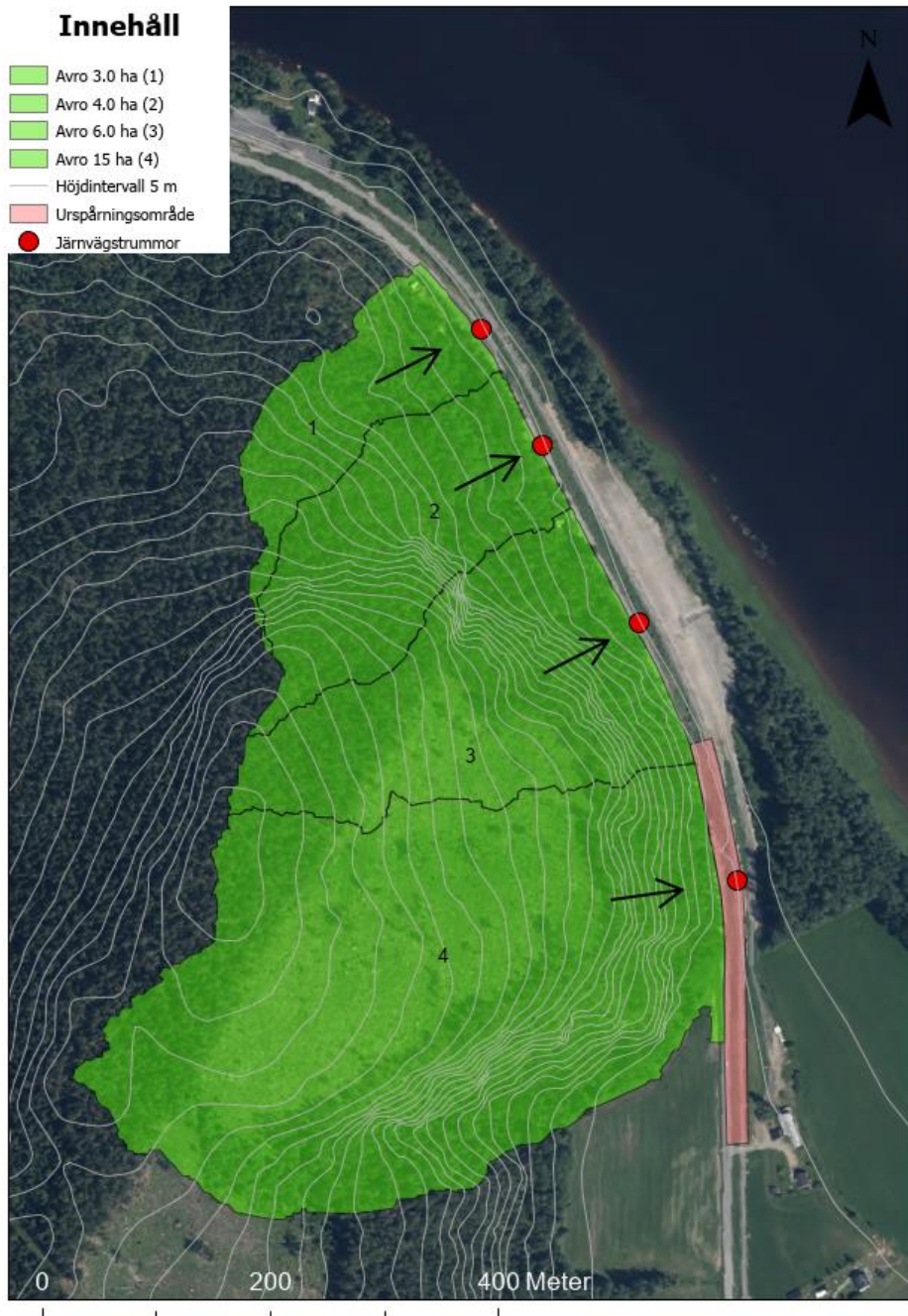
Figur 16. De fyra avrinningsområden som avleder vatten till området mellan väg och järnväg. Vattnet från område 4 är det som sannolikt medfört tågurspårningen. Pilar markerar identifierade vägtrummor och de röda prickarna järnvägstrummor försedda med kupolsilar.
