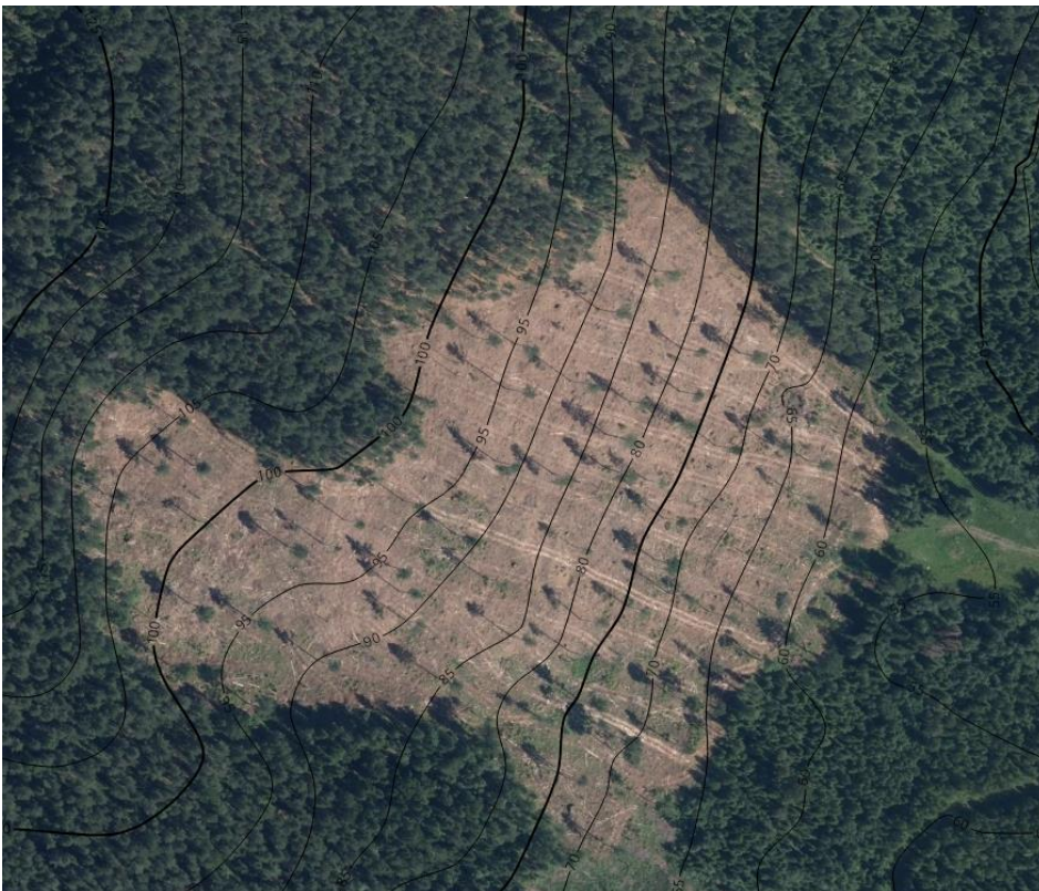
Figur 20. Bandfordon som kört vinkelrätt mot höjdkurvor och därmed påskyndar avrinningsförloppet.
