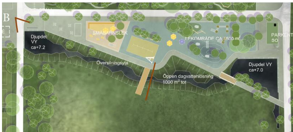
Figur 24 Illustration som visar hur en öppen dagvattenlösning kan utformas som en del av parken. Detaljplanen möjliggör för olika lösningar. White Arkitekter.
