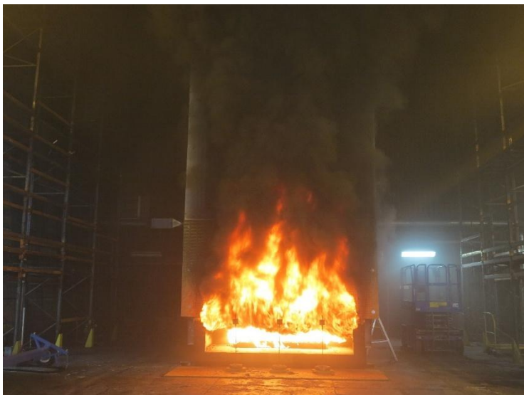
Figur 26. Bild tagen under kalibrering utan något brännbart på testtriggen. Foto erhållen från RISE.
