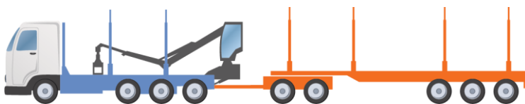
Figur 9. Exempel på ett ekipage med nio axlar och maximal bruttovikt om 74 ton varav 42 ton på vagnen och 32 ton på bilen. Källa: Skogforsk 82
