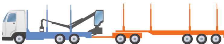
Figur 8. Exempel på ett ekipage med åtta axlar och maximal bruttovikt om 70 ton varav 42 ton på vagnen och 28 ton på bilen. Källa: Skogforsk 82
